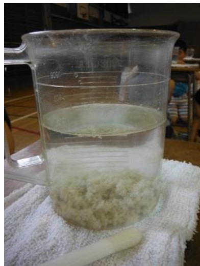
にごり水の汚れを凝集させて沈殿させて、ろ過しました。
