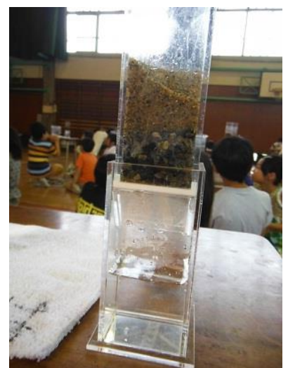
高度浄水処理模型による実演（色水が透明になりました）
