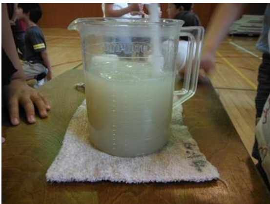
にごり水の汚れを凝集させて沈殿させて、ろ過しました。
